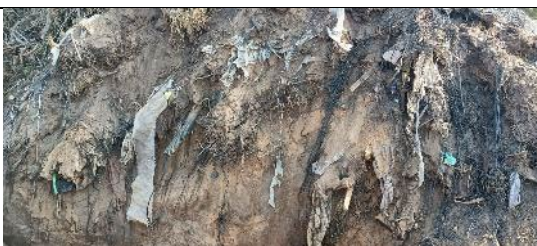
איור 77: תעלה בתוך הסוללה דרום מערבית דוגמא YA-12, תכריב על הרכב הפסולת. בתוך הקרקע נצפה חומר כהה (ככל הנראה כתוצאה של שריפה) וכ-10% פלסטיק (חוטי הדלייה, שקיות פלסטיק וצינורות PVC)
