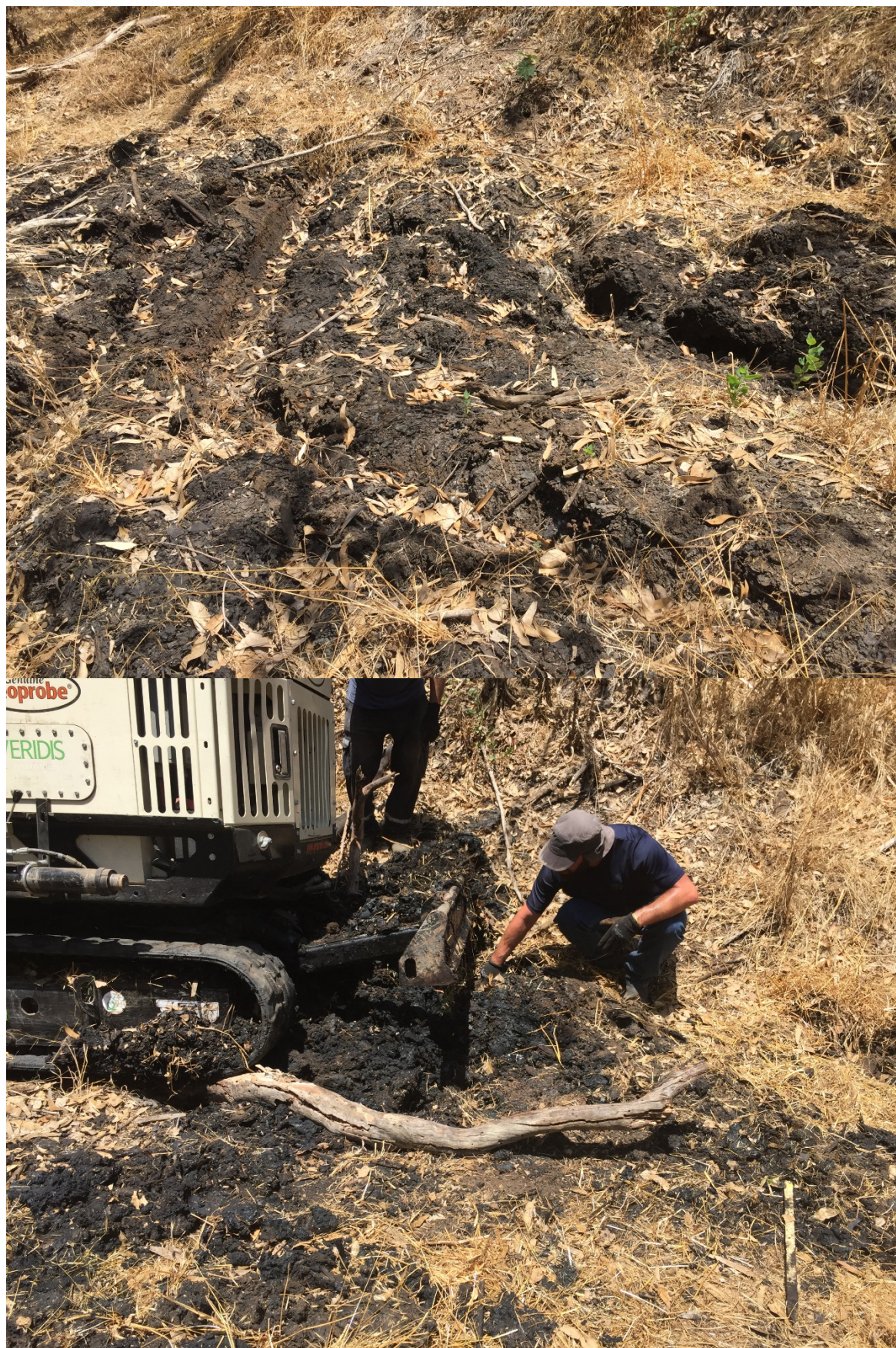
תמונה 5 : שקיעת המקדח בתוך בוצת שמן, כאשר על פני השטח ישנה שכבת קרקע ועלים.
