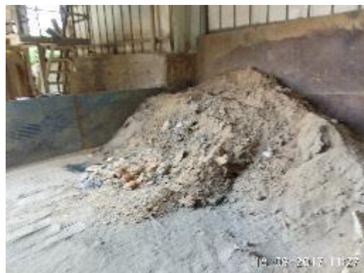
תמונה 15 – אבקת אבץ בתא מפעל מיחזור. נומינור
