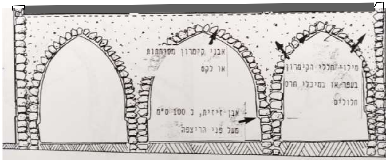
חתך במבנה קמרונות עם גג שטוח ופירוט מרכיבי הבנייה. מקור: משרד שפר את רונן הנדסת שימור בע"מ
