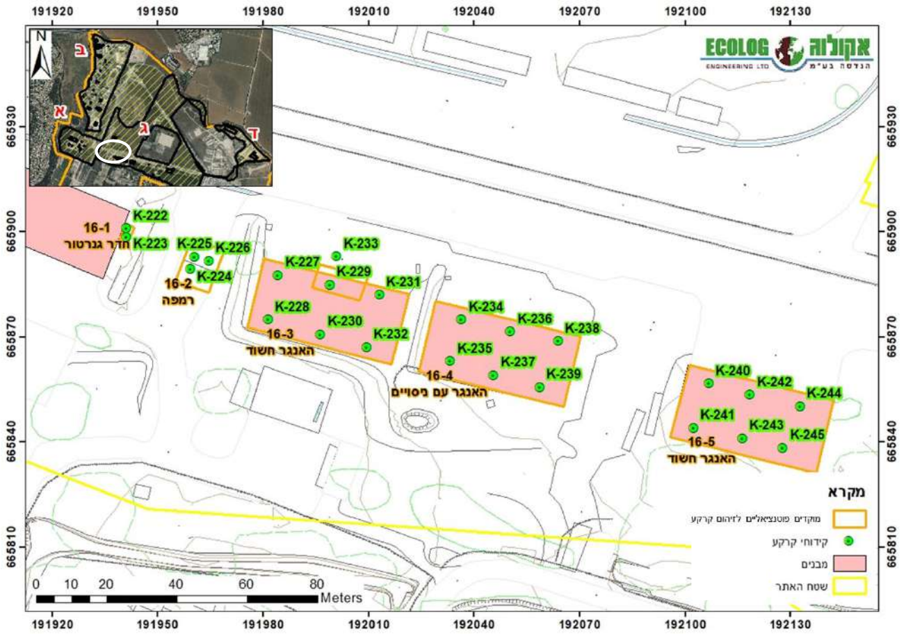
איור 32. פריסת קידוחי הקרקע המתוכננים במתחם ג', אזור 16, על רקע מפת מדידה של האתר
