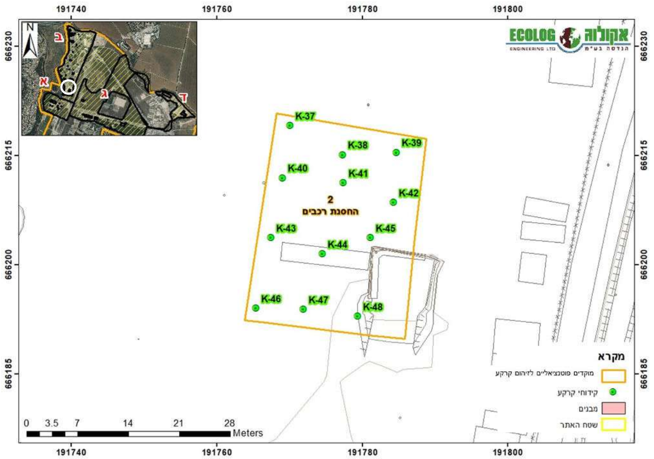
איור 16. פריסת קידוחי הקרקע המתוכננים במתחם ב', אזור 2, על רקע מפת מדידה של האתר
