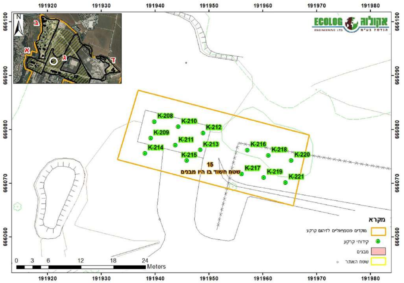
איור 31. פריסת קידוחי הקרקע המתוכננים במתחם ג', אזור 15, על רקע מפת מדידה של האתר
