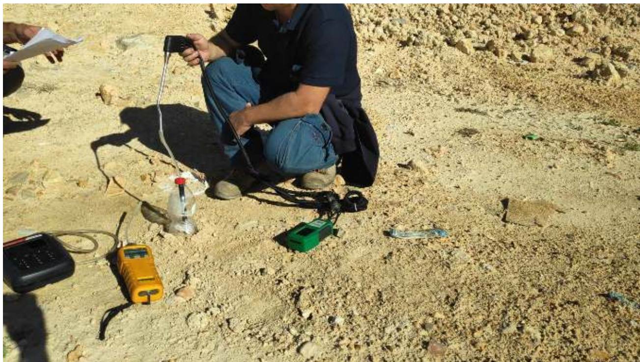
תמונה 1 – מיפוי גזי מטמנה באמצעות מכשיר גז אנלייזר
