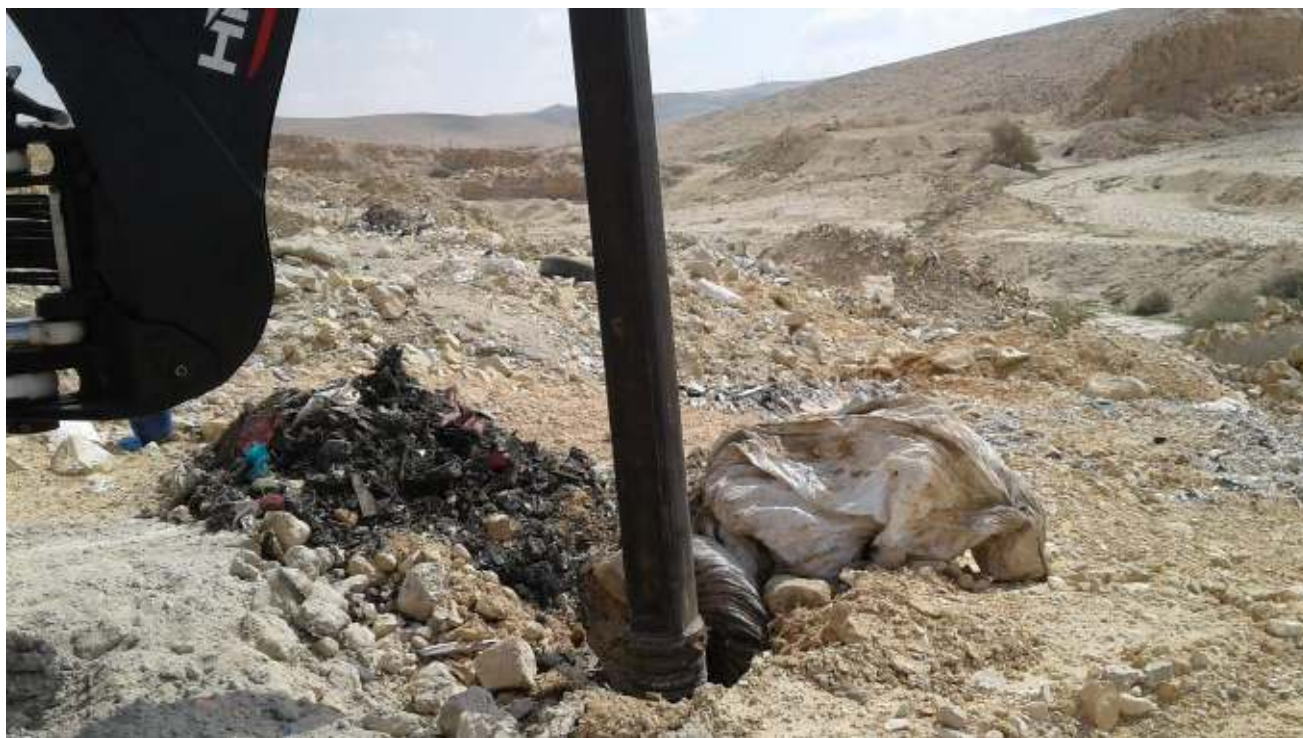
תמונה 5 – קידוח כלונסאות לאפיון פסולת (K-8)
