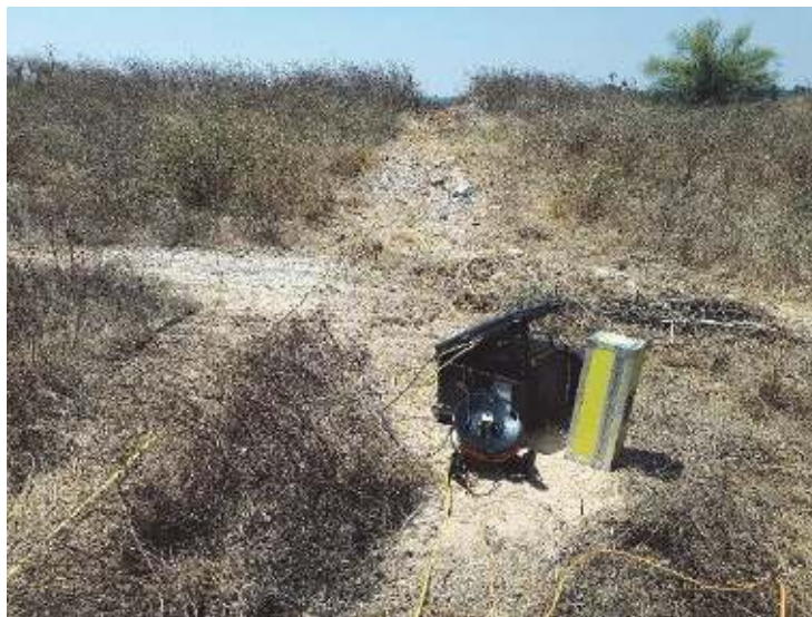
איור 4. ציוד גיאופיזי גיאושמלי הכולל משדר, מד מתח ומחשב מרכזי כיחידה אחת.
