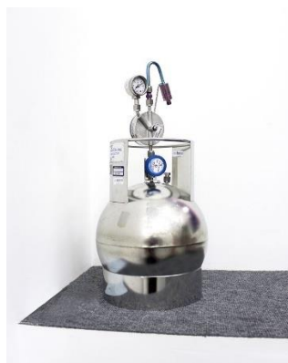
תמונת אילוסטרציה – קניסטר לבדיקות לפי שיטה TO - 15
