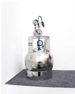
תמונת אילוסטרציה 1. קניסטר לבדיקות לפי שיטה TO - 15
