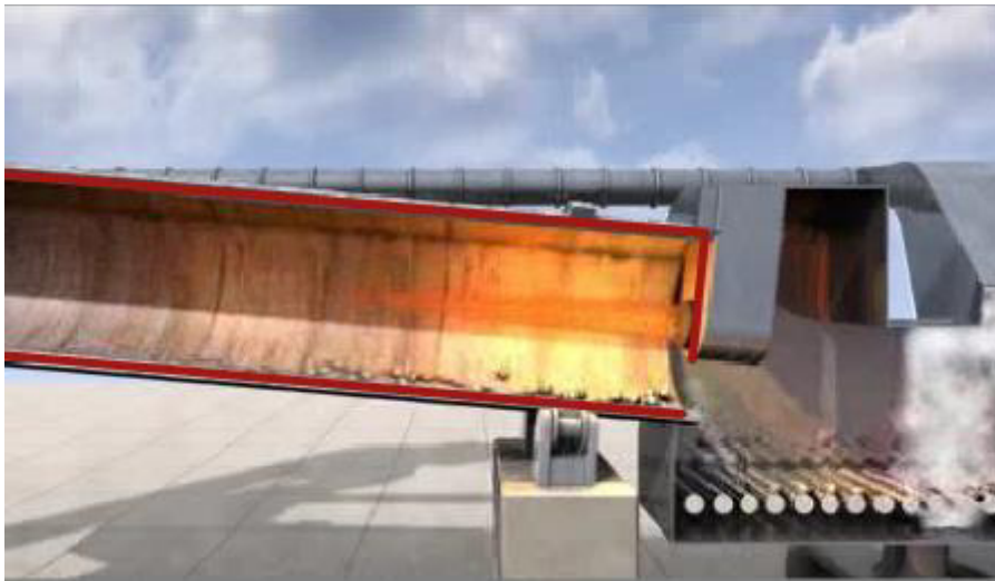
איור מס' 9: הכבשן המסתובב של ייצור הקלינקר במפעל נשר
