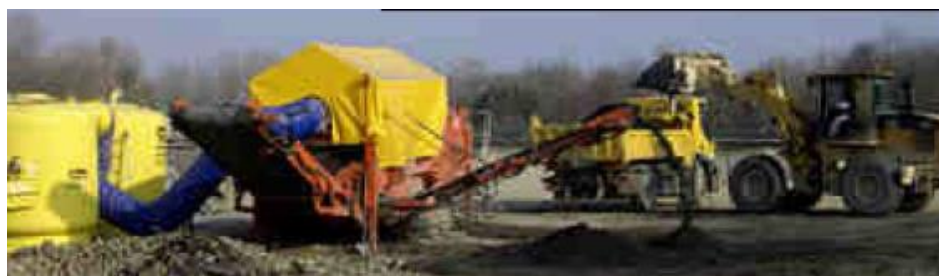
איור 19: מתקן TD בחימום ישיר של חברת Astec
