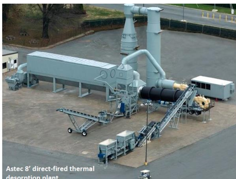
איור 19: מתקן TD בחימום ישיר של חברת Astec
